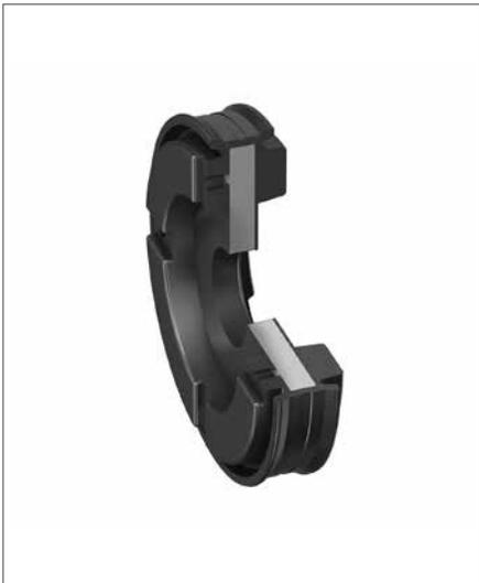
Der doppelwirkende Pneumatik-Komplettkolben DP ist ein Zwei-Komponenten-Dichtungsdesign, bestehend aus einem metallischen Trägerelement mit anvulkanisiertem Führungssteg und Dichtlippen. Der Komplettkolben erfüllt drei Funktionen: **Abdichten, Führen und Endlagendämpfung.**
