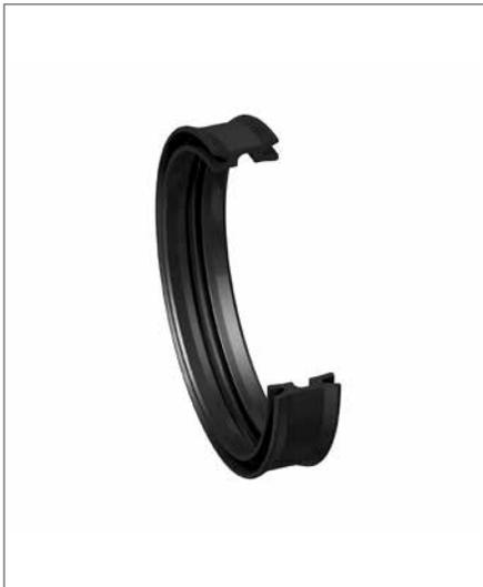
Die Pneumatik-Kolbendichtung Z5 ist ein Doppelnutring mit Führungssteg für doppeltwirkende Kolben. Die Dichtung hat zwei Dichtlippen und zeichnet sich daher durch besondere Dichtheit aus.
