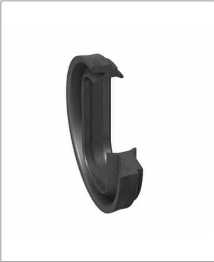
Der Ultrathan® Dicht-Abstreifring EF für abgeflachte Kolbenstangen von verdrehgesicherten Pneumatikzylindern ist das ovale Pendant zum runden Standard-Profil EL. Er erfüllt zwei Funktionen: Dichten und Abstreifen.
