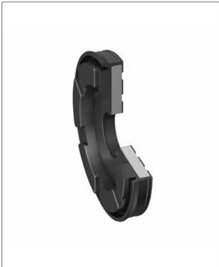
Der einfachwirkende Pneumatik-Komplettkolben DE ist ein Zwei-Komponenten-Dichtungsdesign, bestehend aus einem metallischen Trägerelement mit anvulkanisiertem Führungssteg und Dichtlippe. Der Komplettkolben erfüllt drei Funktionen: **Abdichten, Führen und Endlagendämpfung.**
