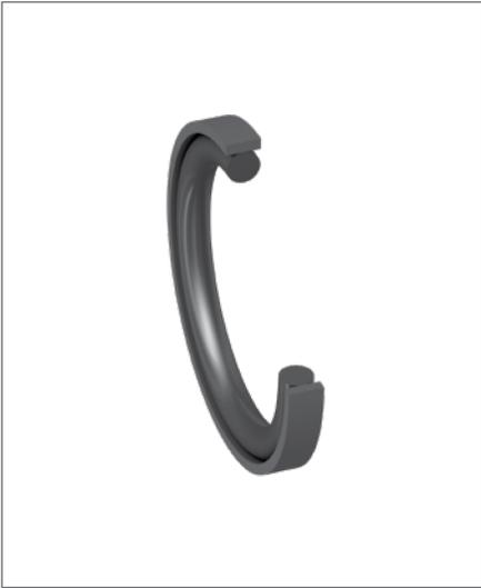
Der doppelwirkende Kolbendichtsatz OA im Slipper Seal® Design besteht aus einem PTFE-Kolbendichtring und einem Elastomer-O-Ring als Vorspannelement. Das Dichtungsdesign ist für pneumatische Anwendungen konzipiert. Der symmetrische Querschnitt des Dichtringes ist für gleichmäßige Schmierfilmbildung während des Hubes in beiden Richtungen ausgelegt. Der Dichtsatz OA eignet sich besonders für doppelseitig beaufschlagte Kolben.
