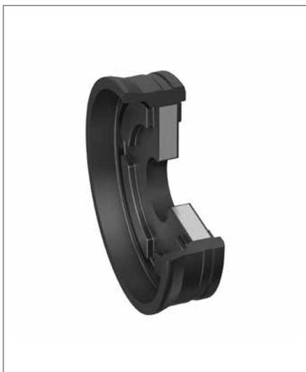
Der einfachwirkende Pneumatik-Komplettkolben EK ist ein Zwei-Komponenten-Dichtungsdesign, bestehend aus einem metallischen Trägerelement mit anvulkanisiertem Führungssteg und Dichtlippe. Der Komplettkolben erfüllt zwei Funktionen: **Abdichten und Führen.**
