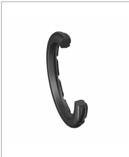
Der Dämpfungsring V6 dichtet Dämpfungskolben in Pneumatikzylindern im Endlagenbereich ab. Die Kompaktdichtung sorgt für Dichtwirkung zum Dämpfungskolben und ermöglicht gleichzeitig eine Ventilfunktion beim Rückhub. Die Kombination aus Geometrie und Werkstoff ermöglicht kleine Einbauräume.
